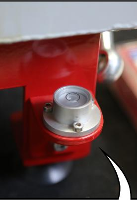
DAS WERKZEUG ZUR SCHWIMMERGEHÄUSE-KRAFTSTOFFNIVEAUPRÜFUNG UND EINSPRITZMENGE-EINSTELLUNG. IN SHORT A LEVEL TABLE WITH AN ELECTRICAL FUEL PUMP AND A RESERVOIR TO CATCH THE SPILLED FUEL..
